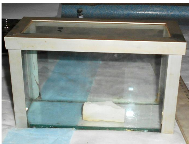
Figure 4: Montage d'une CCM
