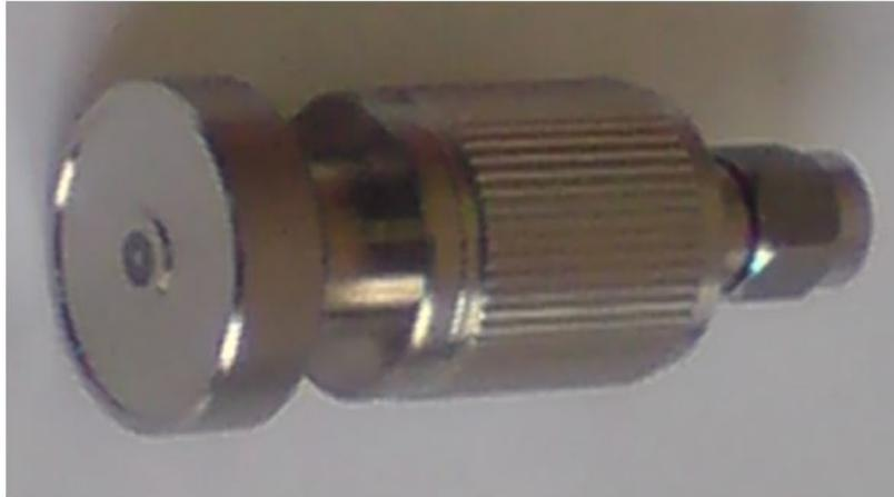
FIGURE 2.5 – Sonde coaxiale pour la caractérisation électrique jusqu'à 20GHz [22]
