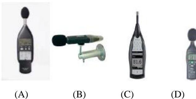
Figure 8: (A) Sonomètre intégrateur ; (B) Sonomètre wifi ; (C) Sonomètre analyseur ; (D) Sonomètre à deux gammes de mesure
