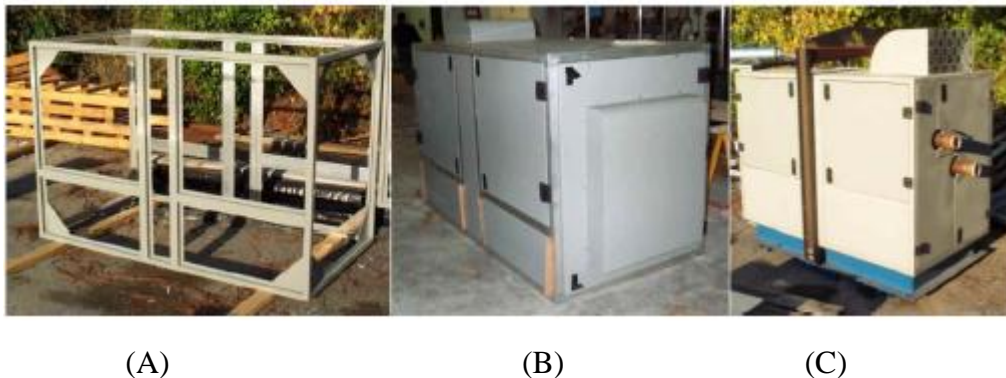
Figure 4: (A) Structure typique d'un encoffrement : carcasse support, (B) Panneaux avec trappes de visite, (C) Encoffrement monté sur socle avec ouvertures pour aération (10)
