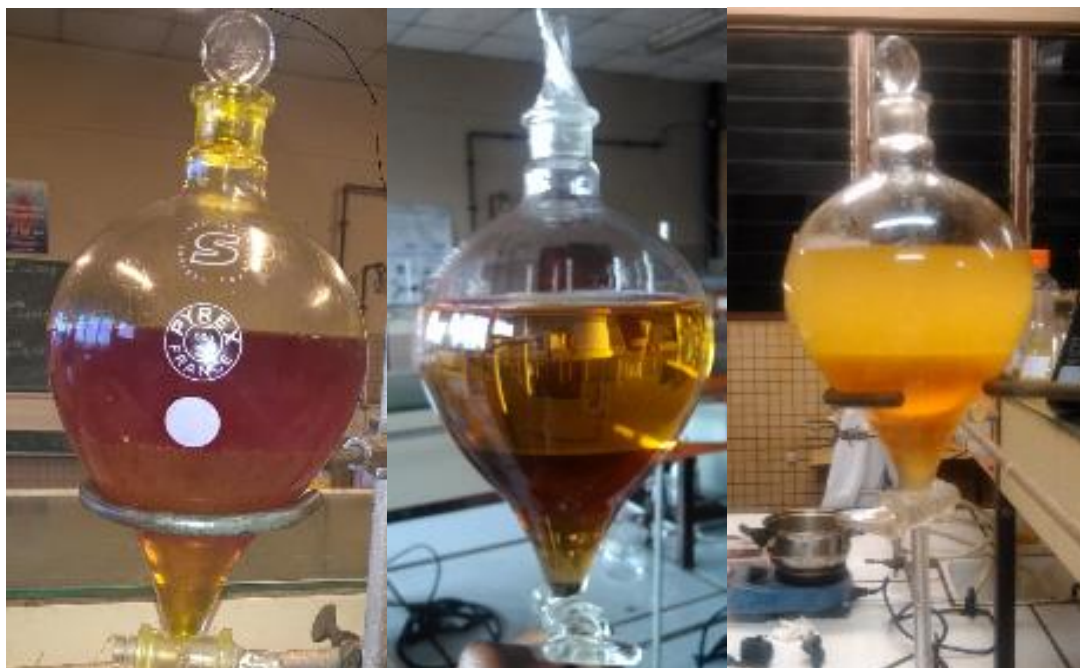
Figure 4. Résultat transestérification des huiles de palme, palmiste et de coton
