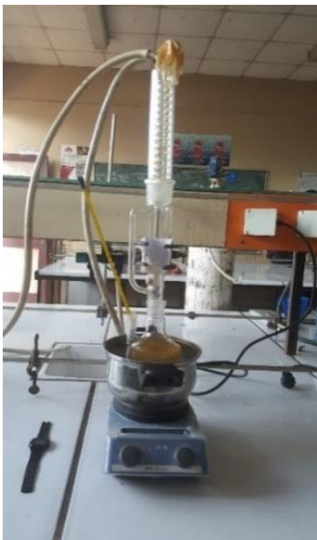
Figure 2. Montage à reflux pour la réaction de transestérification
