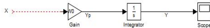
FIGURE 3.3 – schéma bloc électronique dans MATLAB SIMULINK de la deuxième équation du système dynamique.
