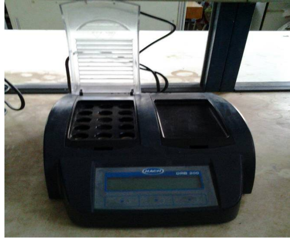
Figure 34 : photo du digesteur.
