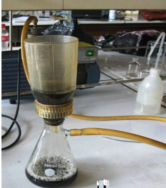
Figure 25 : Dispositif de filtration sous-vide. Figure 26 : photographie du lixiviat
