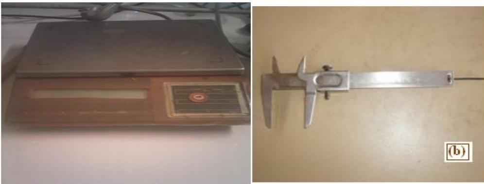
**Figure2-4 :(a) Balance numérique de marque OHAUS CS 200 de précision 0,1g et (b) Pied à coulisse de précision 0,1mm**
