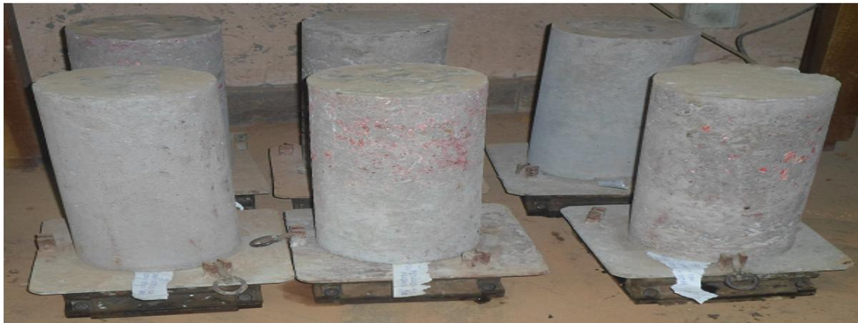
FIGURE 2.12 – Conservation des éprouvettes moulées.
