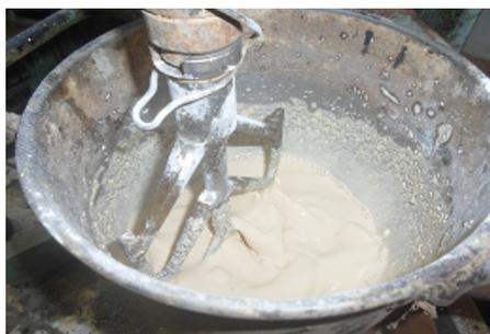
FIGURE 2.9 – Malaxage des additifs et du métakaolin.
