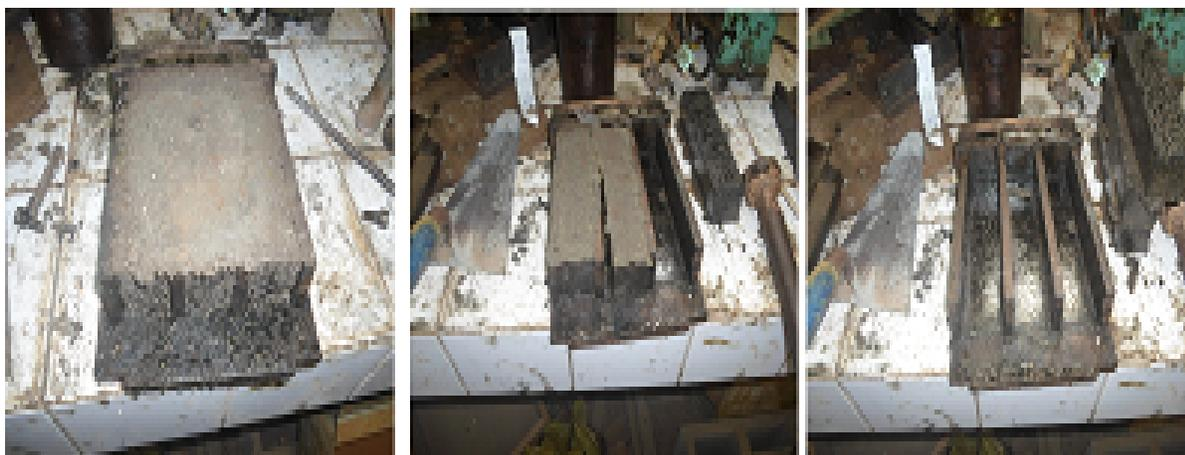
FIGURE 2.13 – Démoulage des éprouvettes.
