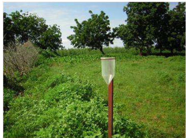
Photo 5 : Pluviomètre à lecture directe installé dans la partie amont du kori Tyala
