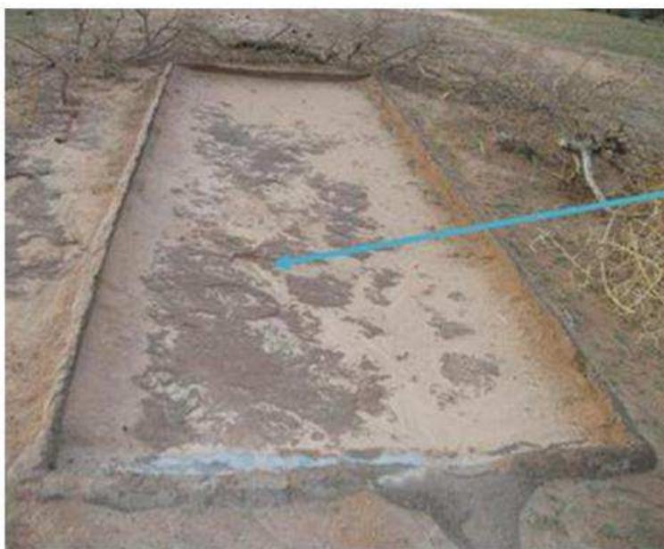
Photo 41: Formation d'une griffe liée à l'effet du cumul vers l'aval de la lame d'eau ruisselée
