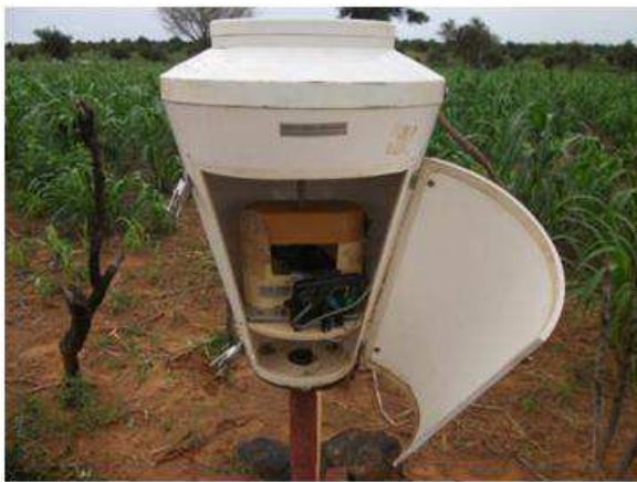
Photo 4 : Pluviographe installé non loin des parcelles expérimentales : il informe sur les caractéristiques (durée et intensité) des averses.
