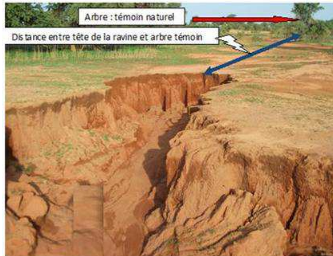
Photo 1 : Dispositif de mesure de la vitesse de ravinement
