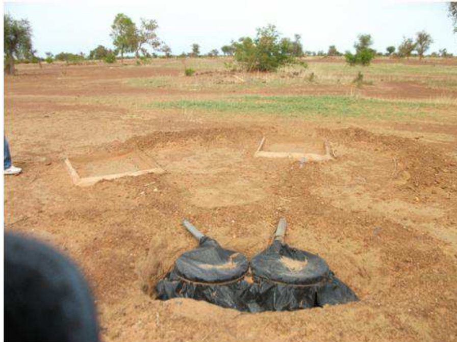
Photo 8 : Parcelles de 1 m 2 installées sur les croûtes gravillonnaires du sommet du plateau. Les fûts sont coupés de moitié du fait de la difficulté à creuser les fosses compte tenu de la dalle de cuirasse se trouvant sur un sol gravillonnaire mince environ 20 cm d'épaisseur.
