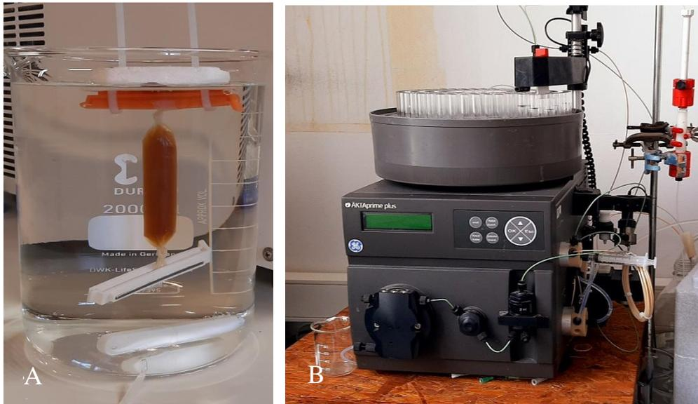
**Figure 27** : Dispositif de dialyse (A) et appareil de chromatographie Akta sur colonne (B)
