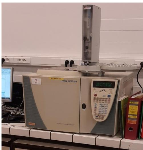
**Figure 25** : Chromatographe en phase gazeuse (Thermo Fisher Scientific Trace GC Ultra)
