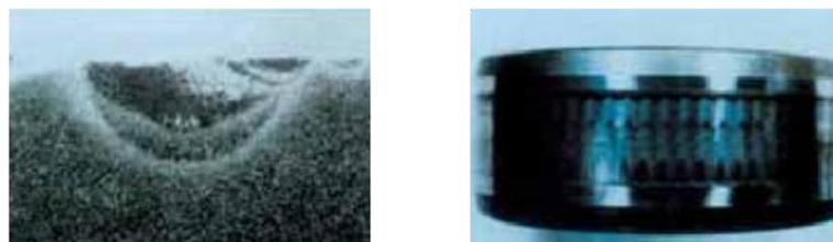
**Figure 10 : courant électrique à travers un roulement [10]**
