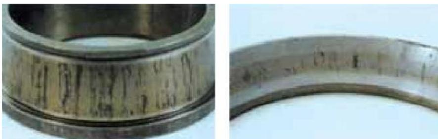
**Figure 3 : la corrosion des pistes [10]**
