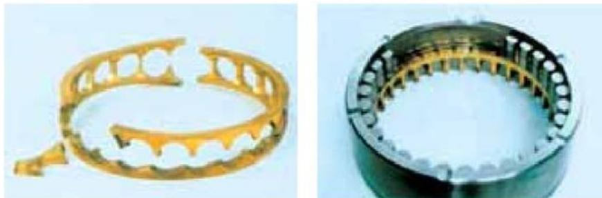
**Figure 9 : rupture de la cage des roulements [10]**
