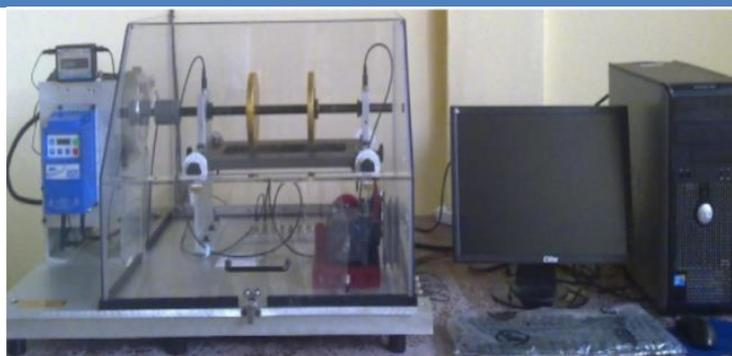
Figure 21 : photo du simulateur de défaut des machines. Ordinateur équipé du logiciel VibraQuest
