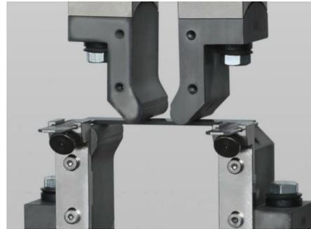
Figure 1-6: exemple de dispositif d'essai de flexion 4 points [12]
