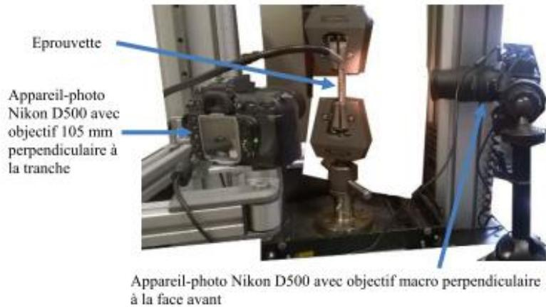
Figure 2-7: Montage de l'essai de traction [23]
