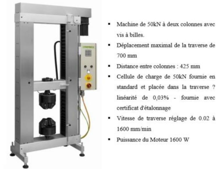
Figure 3-2: machine d'essai de traction [27]
