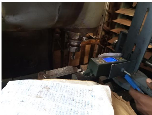
Figure 3-6: Processus de mesure de la rugosité sur site
