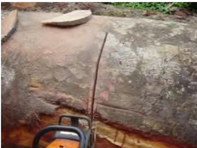
Figure 5 : Perçage de la grume en mortaise (pour éviter de coincer la lame de scie)
