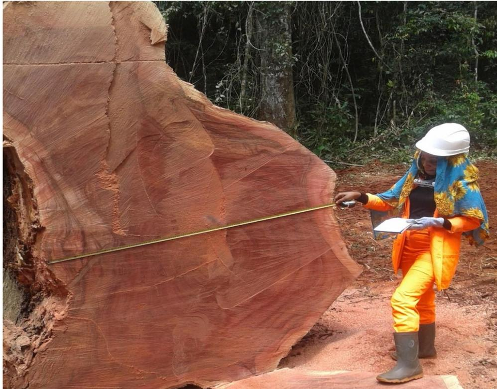
Figure 12: Prise de mesures pour calcul du tonnage d'un Sapelli arrivé au parc avec contreforts
