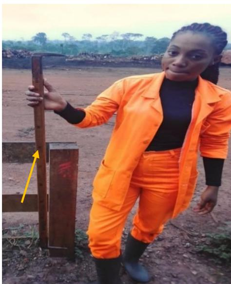
Figure 8 : mètre à pic pour prise de longueurs des grumes.
