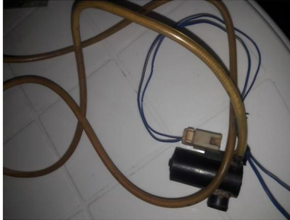
Figure 26- Electropompe 12V utilisé pour notre prototypage
