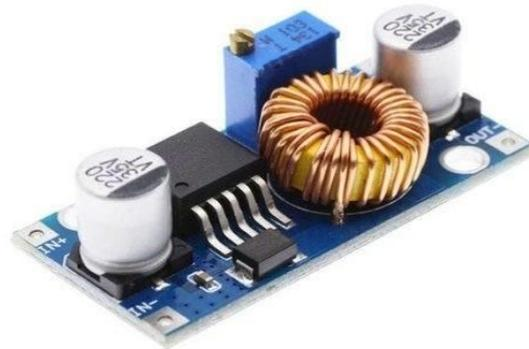
Figure 23- Hacheur dévolteur
