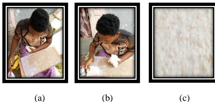
Figure 30: Processus d'encollage du kapok sur le matériau composite
