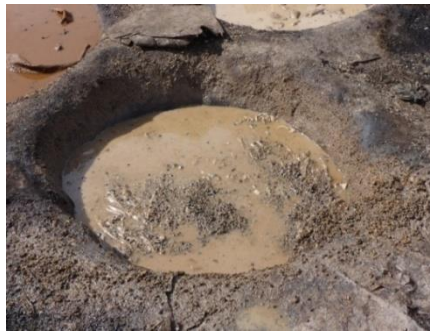
Figure 14 : trempage des peaux dans les fruits d'accacia
