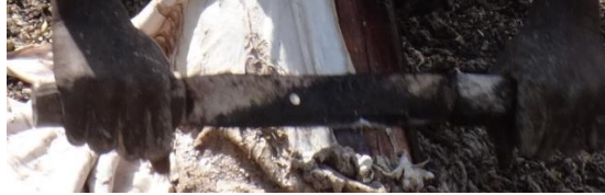
Figure 15 : écharnage des peaux
