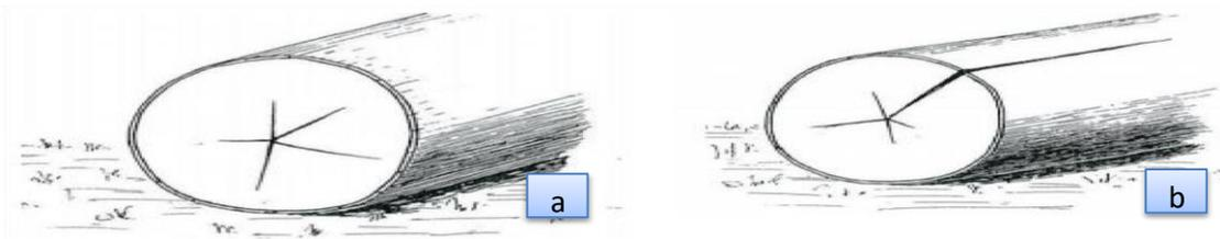
Figure 2.5: Cadranures(a) et fentes(b) sur une Grumes (ATIBT., 2001).
