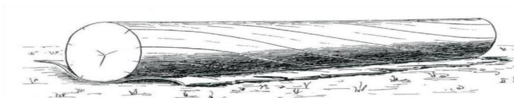
Figure 2.4: Contrefil sur une grume (ATIBT., 2001).
