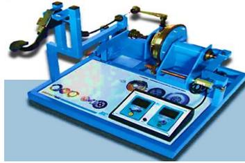
*Figure 1.21* : banc didactique d'embrayage [14]
