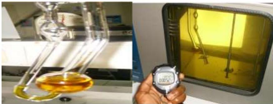
***Figure 2.7: Viscosimètre à tube capillaire***
