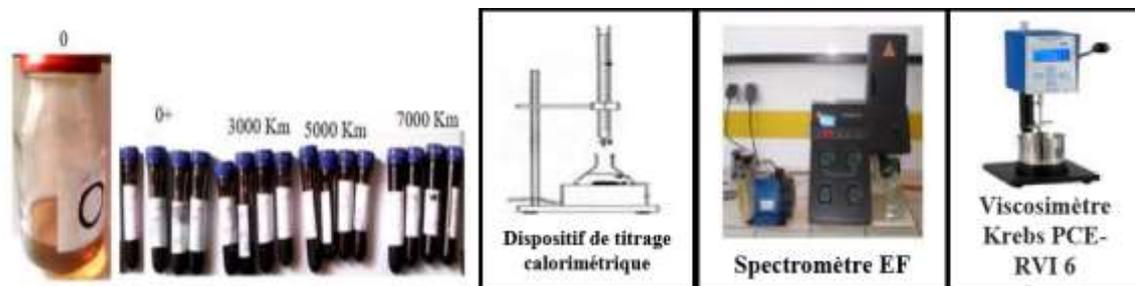
Figure 2.13: Echantillons d'huile et appareil de mesure des propriétés physico-chimique d'huile
