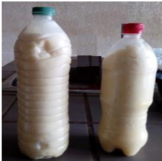
Figure 3.1 : Huile de palmiste brute obtenue après broyage et filtrage
