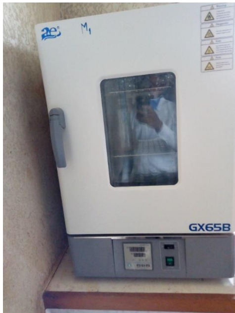
Figure 2.37 : ETUVE de séchage : source HYDRAC Douala
