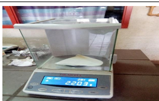
Figure 2.39 : Pesée du filtre après séchage
