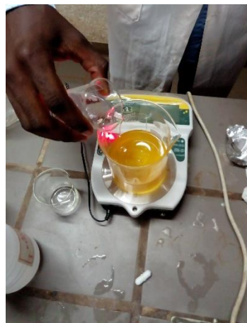
Figure 2.25 : Le mélange de l'alcoolate dans l'huile
