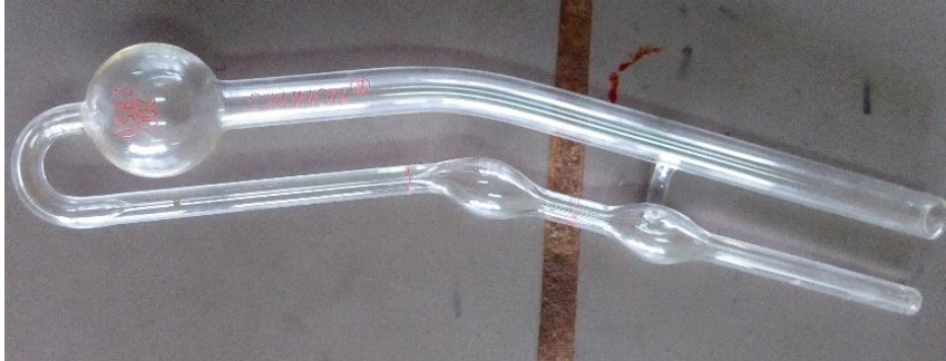
Figure 2.12 : Viscosimètre Capillaire CANNON Z5850
