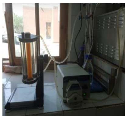
Figure 1.17 : Détermination de la viscosité d'huile
