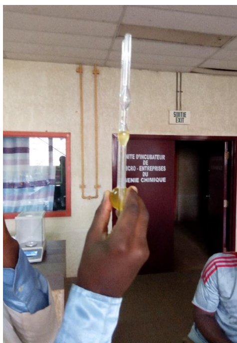
Figure 2.35 : Viscosimètre capillaire de Marque CANNON Z580
