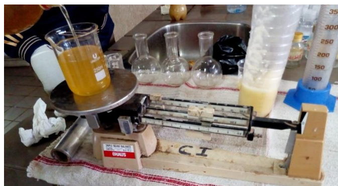
Figure 2.19 : Mesure de la quantité d'huile de palmiste
