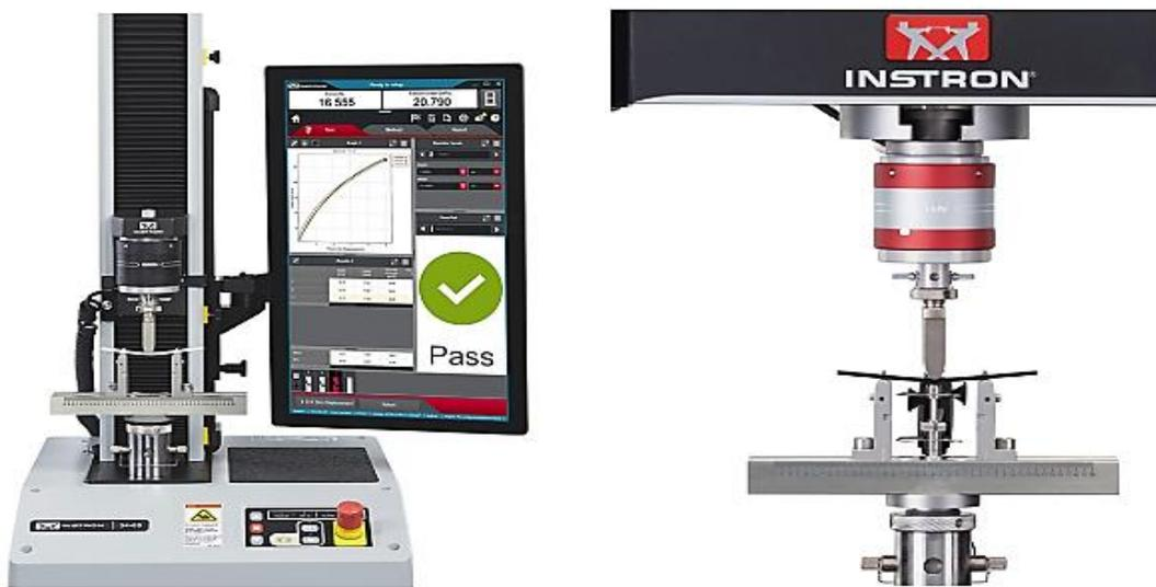
Figure 2.5: Machine INSTRON de technologie de pointe pour l'essai de flexion trois points[21]
