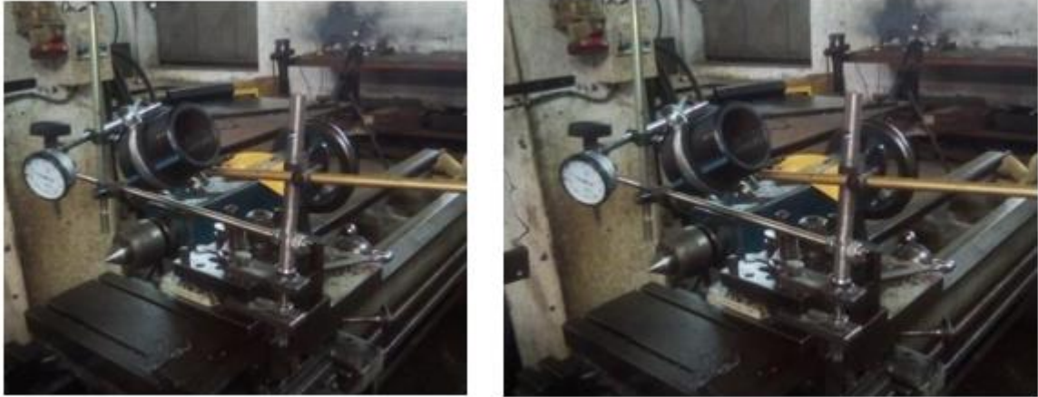
Figure 4.2 : dispositif d'ensemble du bloc porte microscope et comparateur sur site
