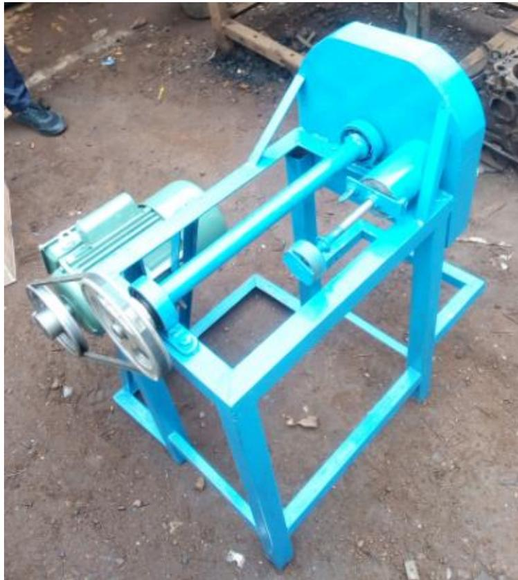
Figure IV.1 : Prototype de la découpeuse de Gnetum
