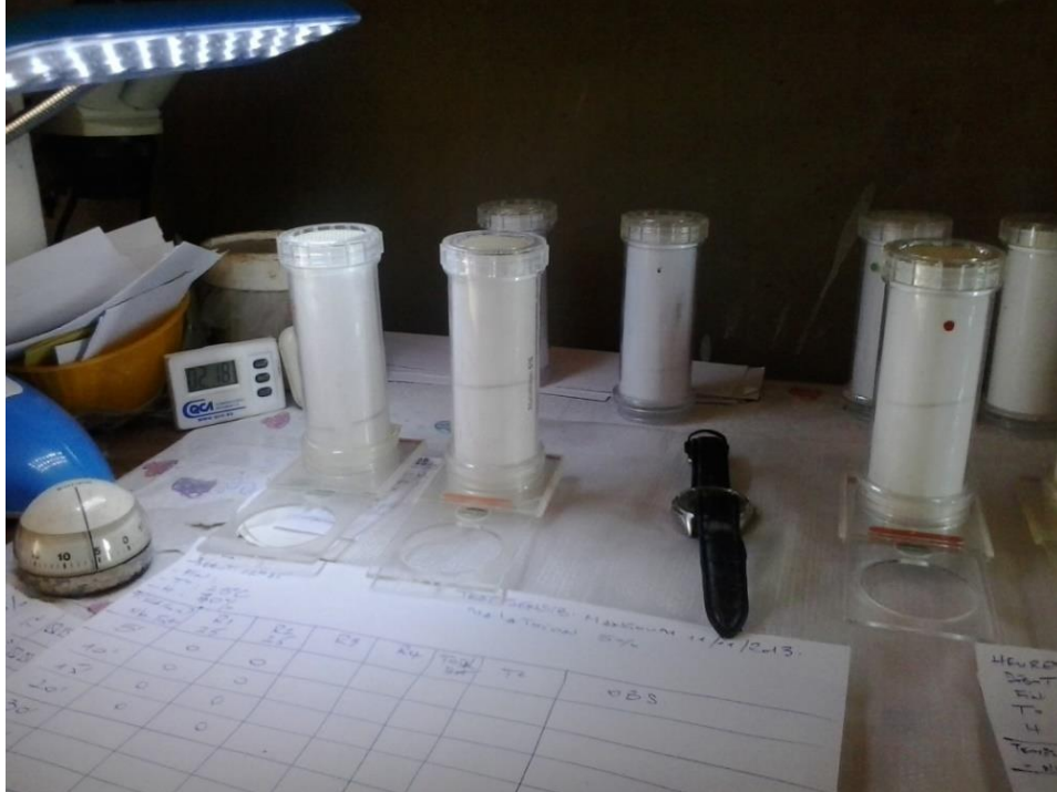
Équipement en attente de la réalisation des tests en tube de sensibilité aux insecticides
