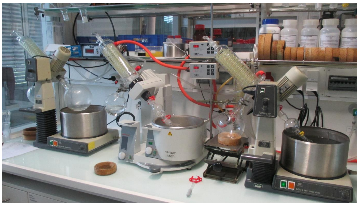
Figure 83: Photo de quelques évaporateurs rotatif de marque Buchi
