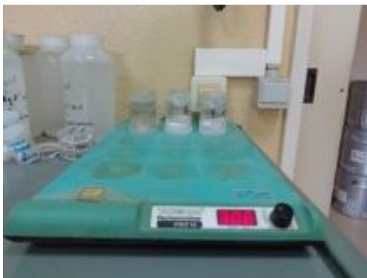
Figure27 : Plaque magnétique pour la déposition du polonium
