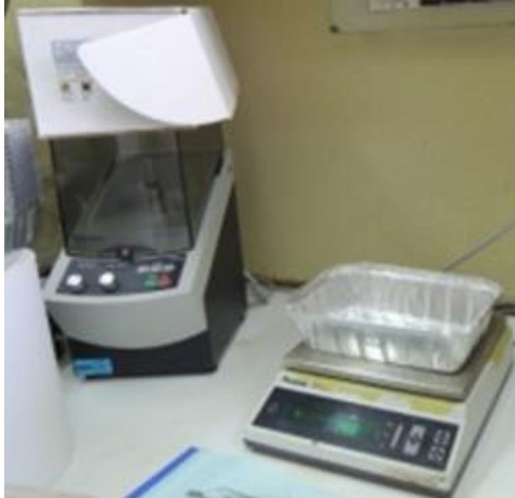
Figure15 : Récipient en aluminium, balance et broyeur (à gauche le broyeur et à droite le récipient en aluminium posé sur la balance).
