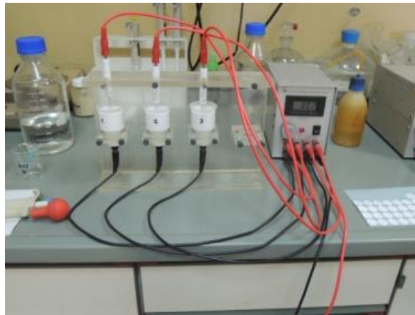
Figure31 : Dispositif d'électrolyse pour électrodeposition
