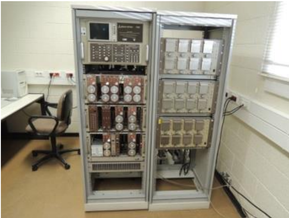
Figure32 : Poste de spectrométrie \alpha . A droite on a six chambres à vides où sont logés les détecteurs, à gauche, on a l'électronique de production et de traitement du signal issu des détecteurs.
