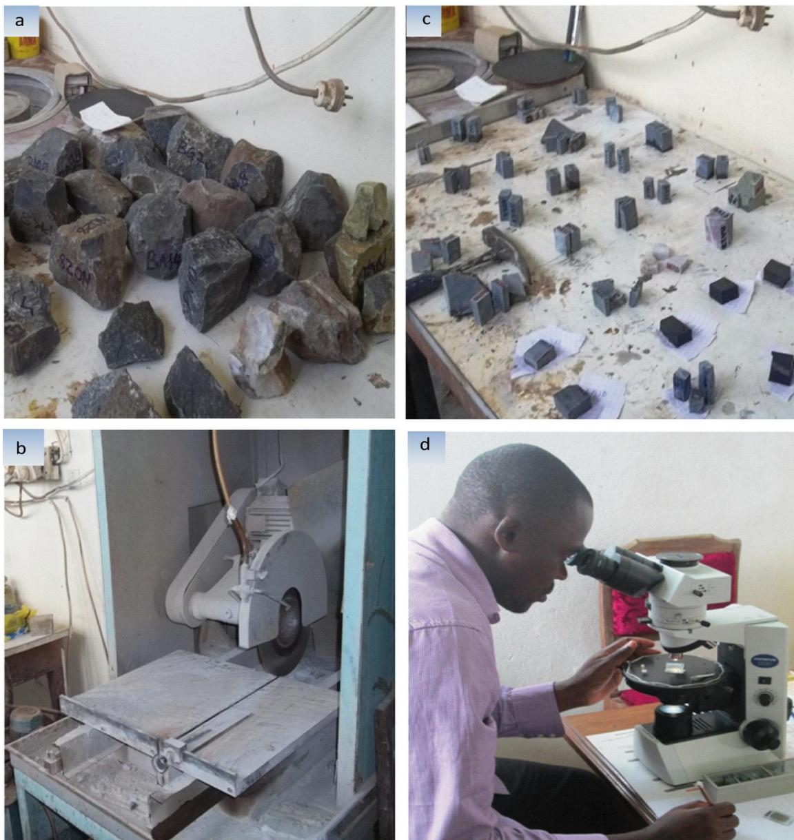
**Figure 11.** (a) Echantillons de roche destinés à la fabrication des lames minces. (b) Machine dotée d'une scie en diamant pour le sciage des échantillons à l'IRGM de Nkolbisson. (c) "Sucres" de roches obtenus après sciage des échantillons. (d) Observation et description d'une lame mince au microscope polarisant binoculaire de marque CX31 Olympus.
