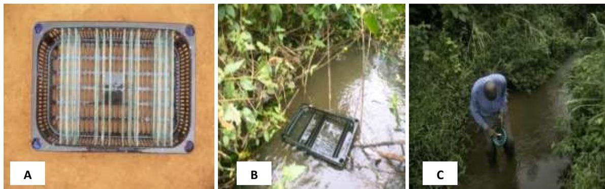
**Figure 14:** substrats artificiels (A) immergés dans la colonne d'eau de la station(B) et prélèvement du biofilm (C)
