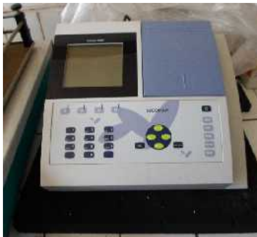
Figure 25: Spectrophotomètre UV-Visible SECOMAM
