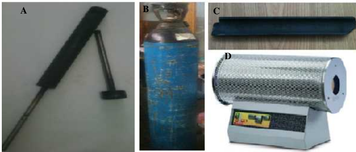
Figure 22: Appareils utilisés pour la préparation du charbon actif : A) Porte creuset ; B) Bouteille à gaz de azote C) ; Creuset ; D) Four à charbon programmable
