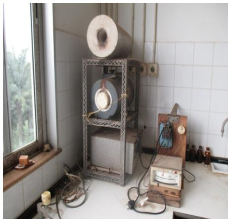
**Four tubulaire ( $t_{\max}=1200^{\circ}\text{C}$ )**
