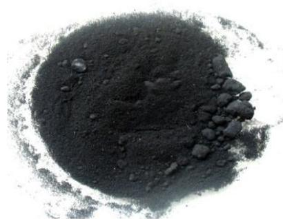
Figure 32 : Photographie de la poudre de CuS obtenue suite au traitement hydrothermal à 100°C.
