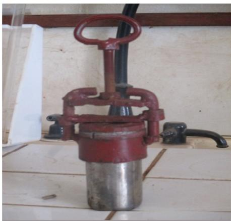
**Mini autoclave en acier inoxydable de 50ml**
