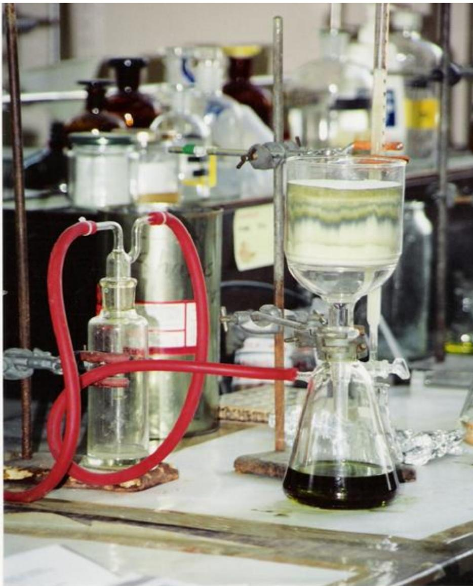
Figure 14: Dispositif expérimental de la chromatographie sous vide (Photographie de Tankeu, 2017)
