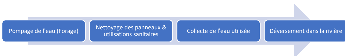
Figure 11 Cycle d'utilisation de l'eau sur le site de la centrale (Source : auteur)
