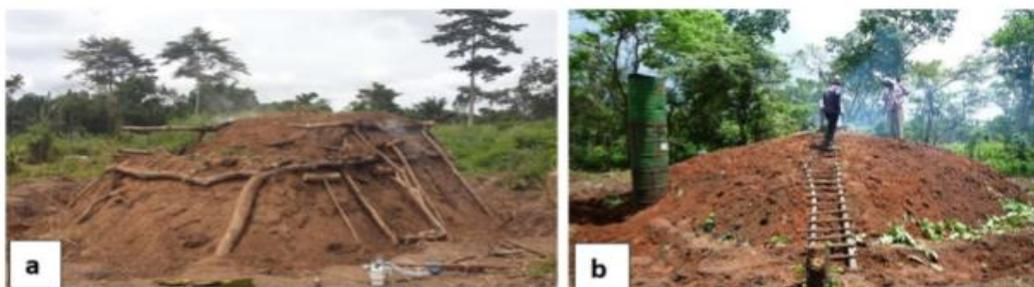
**Figure 5** : Meules traditionnelles utilisées pour la fabrication de charbon de bois, sans cheminée en a) et avec cheminée en b) (Keita, 2018).
