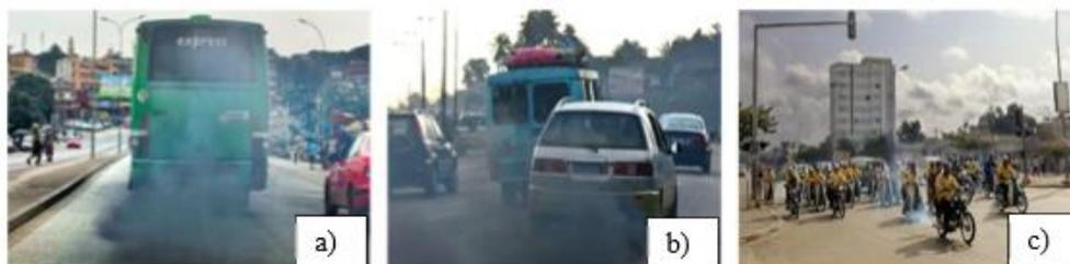
**Figure 4** : Emissions de fumées opaques par les véhicules vétustes à Abidjan en a) et b) et par les engins à deux roues à Cotonou en c) (Keita, 2018).
