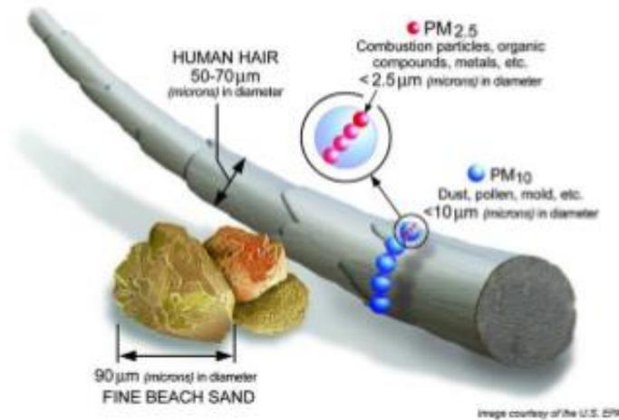
**Figure 7** : Identification de la taille des aérosols à l'aide d'un cheveu humain et d'un grain de sable fin
