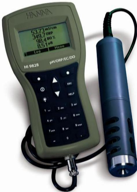
Figure 8 : Multiparamètre de marque Hi 9828 pH/ORP/EC/DO
