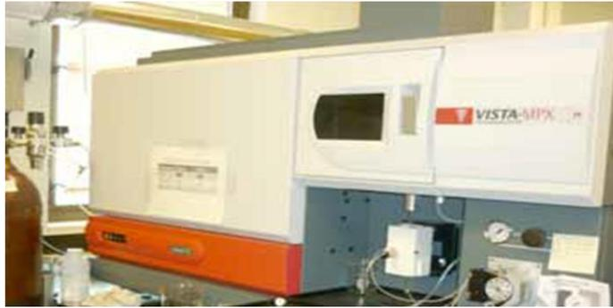
Figure 10 : Spectromètre d'absorption atomique à plasma induit (ICP-AES)
