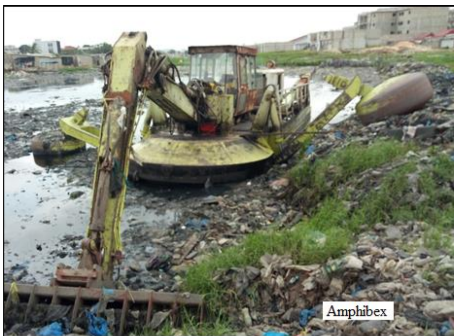
Figure 5 : Engin utilisé pour le faucardage
