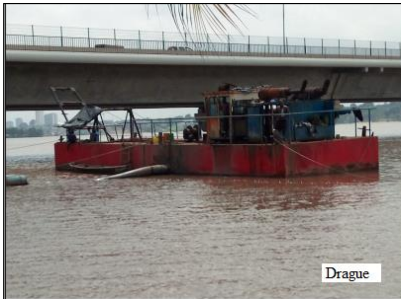
Figure 6 : Engin utilisé pour le dragage hydraulique
