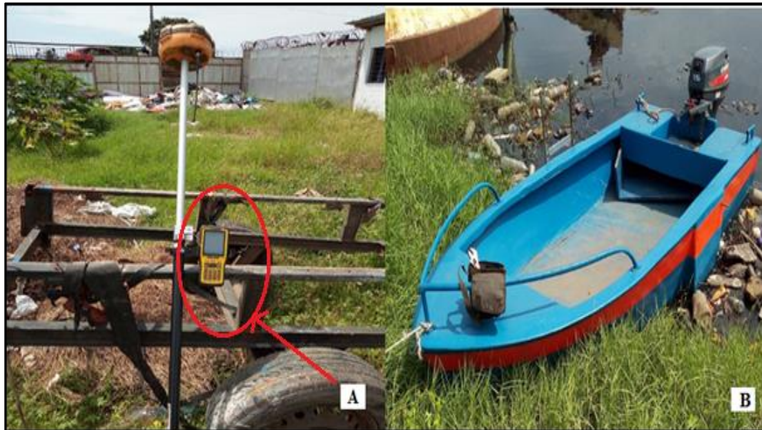
Figure 7 : GPS différentiel Hi-Target V30 Pro (A) ; hors-bord (B)
