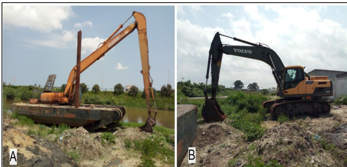
Figure 4 : Engins utilisés pour le curage (A : Big Float ; B : Pelle Long Bras)
