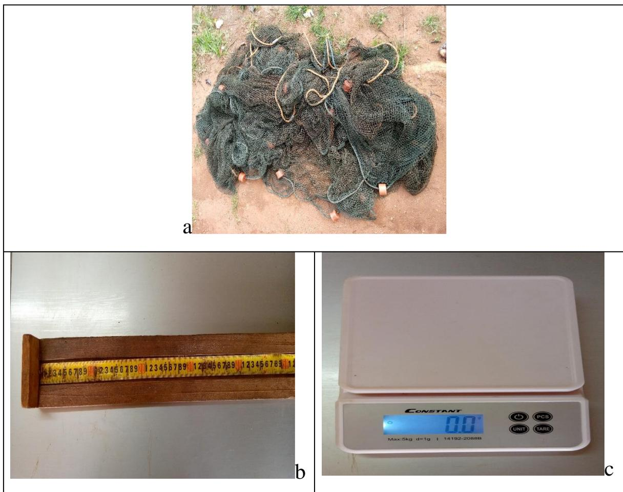
Figure 4: Matériel de capture (a=une senne), de mesure (b=un ichtyomètre) et de pesée (c=une balance électronique)
