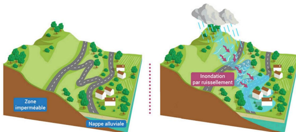
Figure 11 : Inondation par ruissellement pluvial
