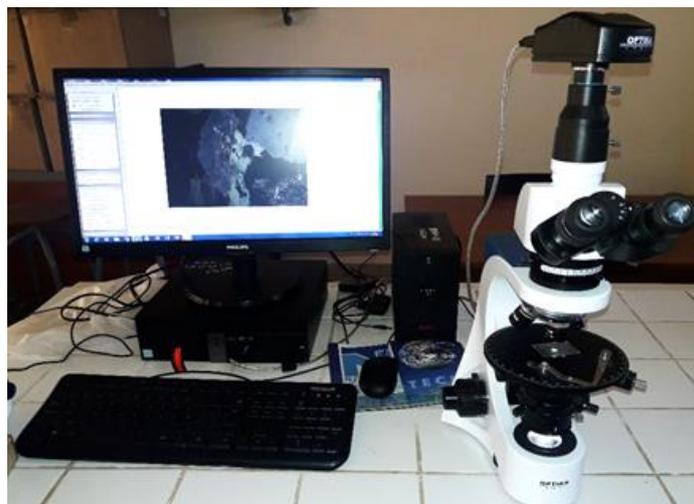
**Figure 6 : Microscope polarisant équipé d'un ordinateur**
