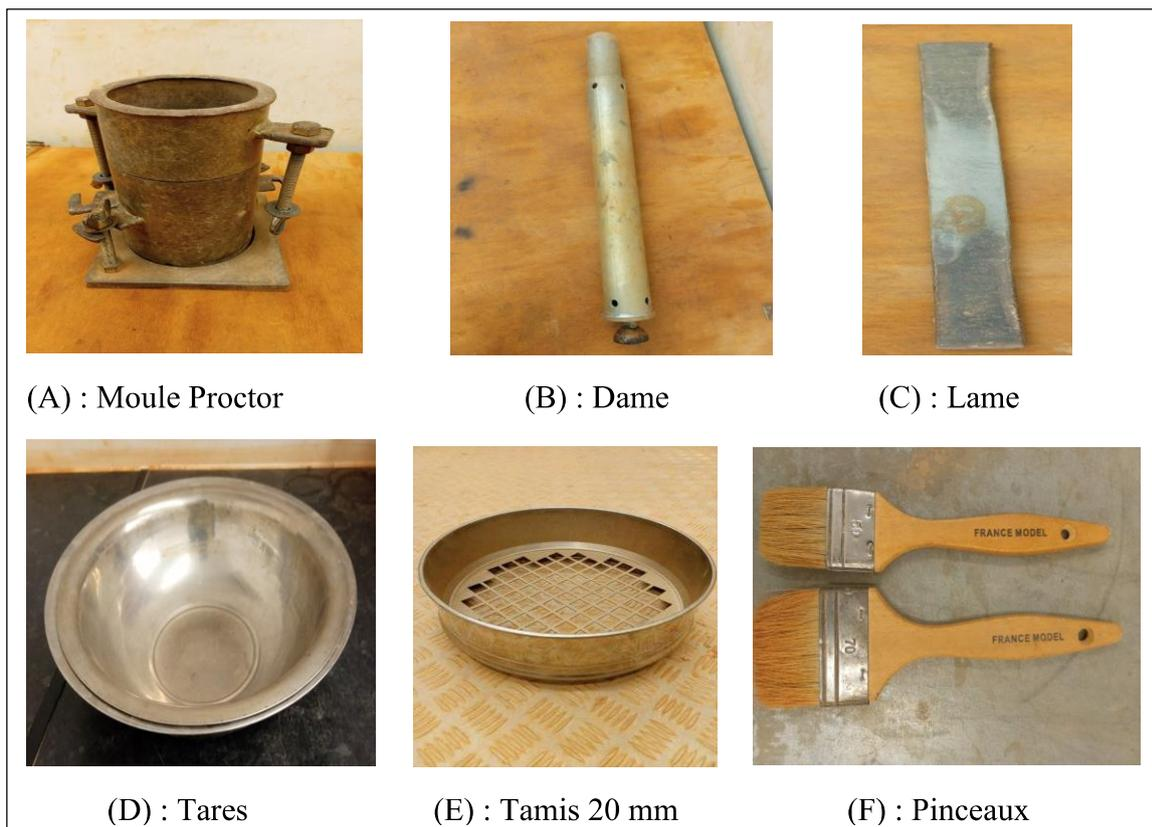
Figure 8 : Matériel pour essai Proctor
