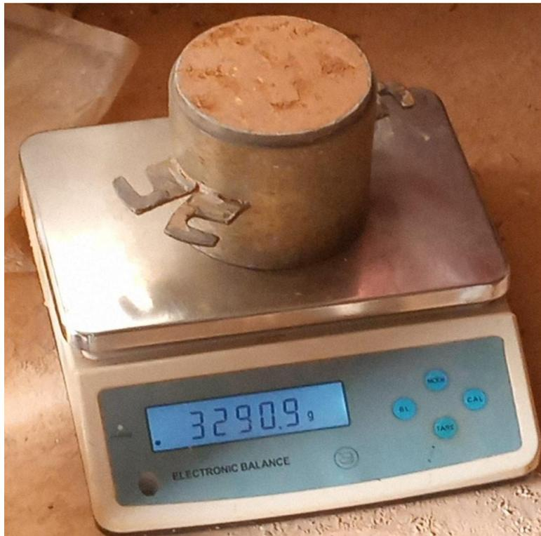
Figure 12 : Pesée de l'éprouvette
