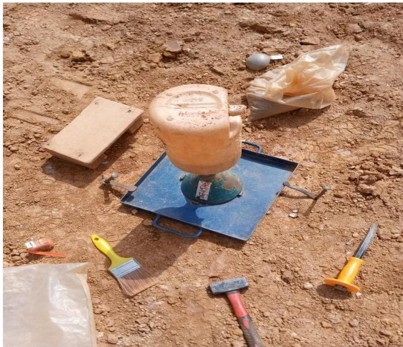
Figure 13 : Essai de densité en cours
