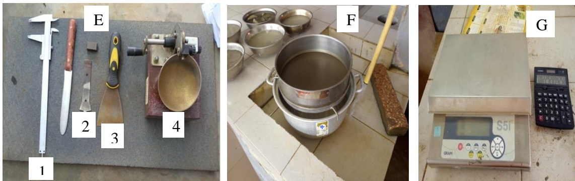
Figure 6. Matériel pour déterminer la limite d'Atterberg (E-(1) Pieds à coulisse, E(2) Rainure; E(3) spatule, E(4) appareil de casagrande, F-Superposition de tamis-cuvette de lavage, G-Balance électrique.).
