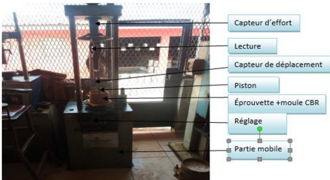
Figure13. Presse CBR (Essai de poinçonnement).
