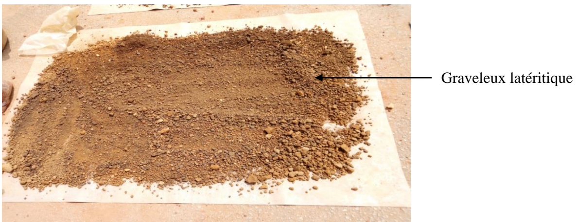
Figure 12. Séchage de graveleux latéritique
