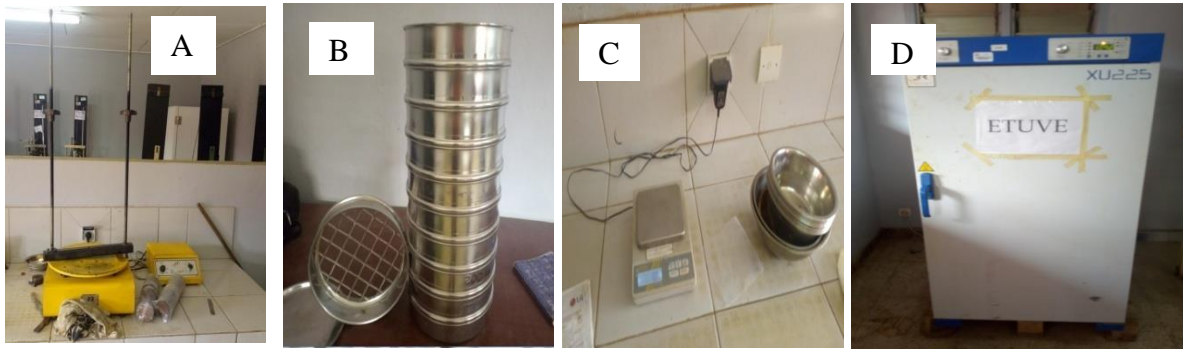
Figure 5. Matériel pour l'Analyse granulométrique (A-Tamiseuse; B-Colonne de tamis ; C-Balance électrique ; D-Etuve).
