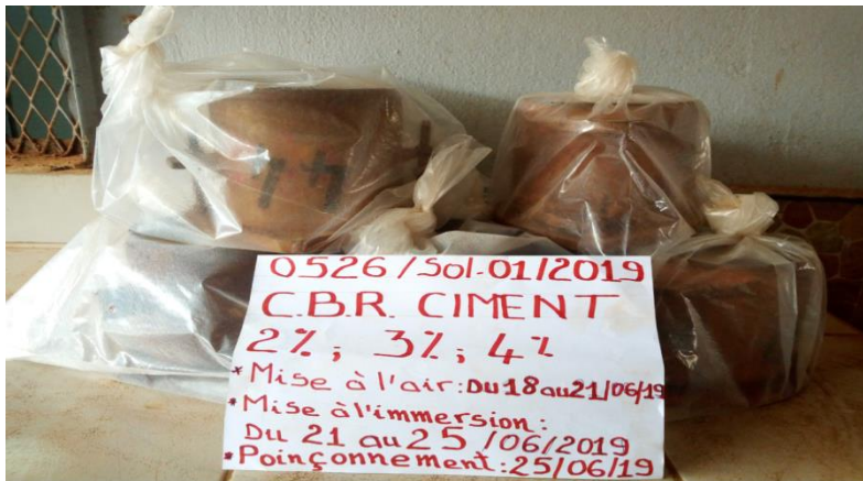
Figure14. Conservation des éprouvettes CBR du graveleux-ciment à l'air et dans l'eau.
