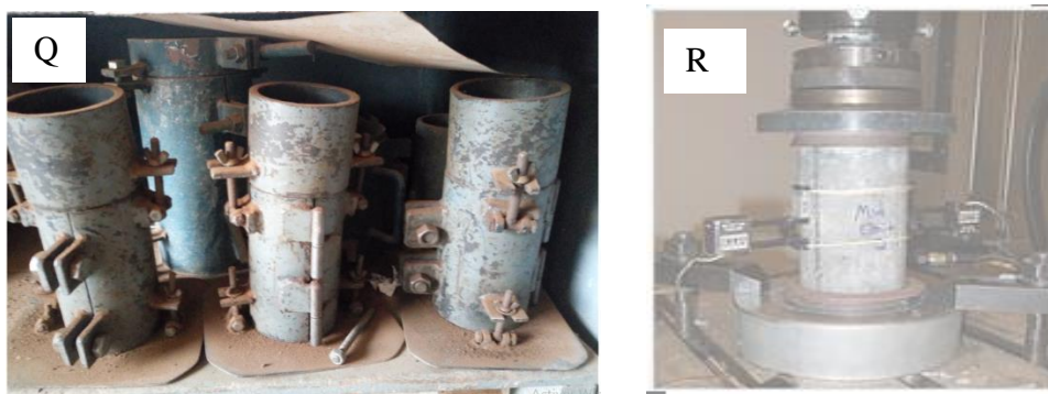
Figure 9: Matériel pour l'essai de compression et de traction (Q-Moules cylindriques, R- Presse)
