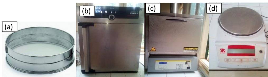
**Figure 11 : Quelques matériels d'étude (a-Tamis ; b-étuve ; c-four ; d-balance)**
