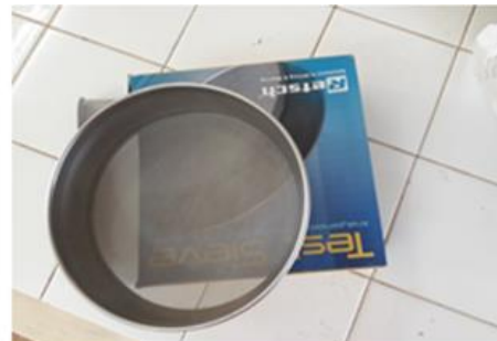
Figure 8 : Mortier en porcelaine et tamis de 200 \mu\text{m} de marque RETSCH
