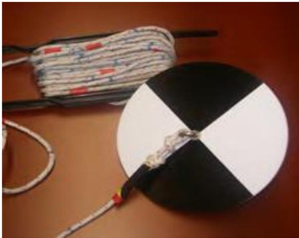
**Figure 3** : Disque de Secchi
