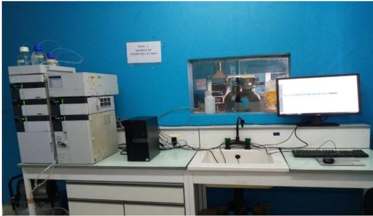
**Figure 8** : Chaîne HPLC SHIMADZU
