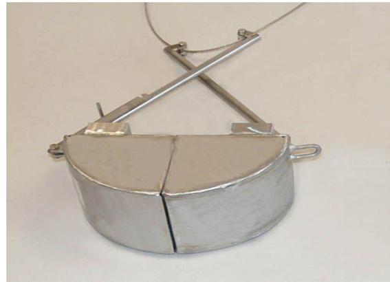
**Figure 6** : Benne type Van Veen
