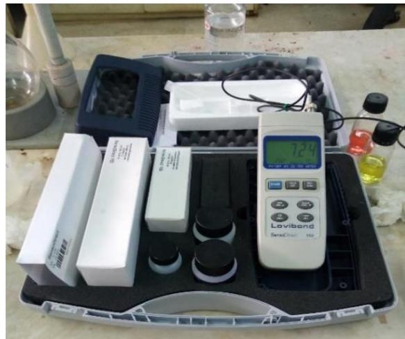
**Figure 4** : Multi paramètre LEVIBOND
