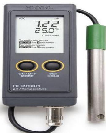
Les **Figure 2** : pH-mètre HANNA                      mesures d'absorbance ont été effectuées avec un spectrophotomètre UV/Visible de marque AQUA LYTIC 800 (Belgique).
