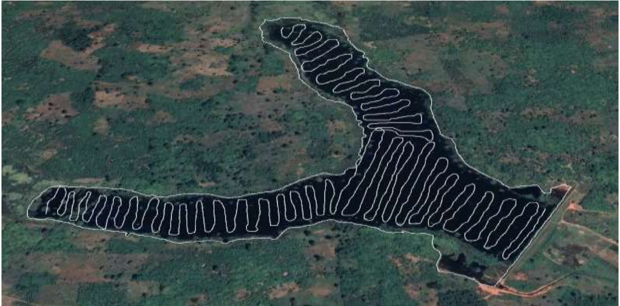
Figure 9 : Aperçu de la zone de réalisation des levées bathymétriques (Google Earth, 2021)
