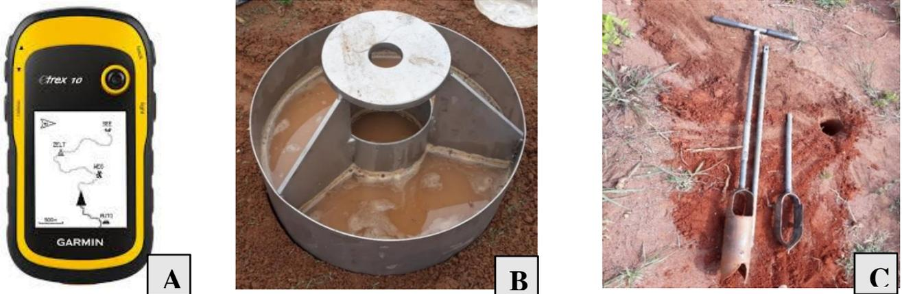
**Figure 5** : Matériel de collecte (A : GPS ; B : Infiltromètre ; C : Tarière)
