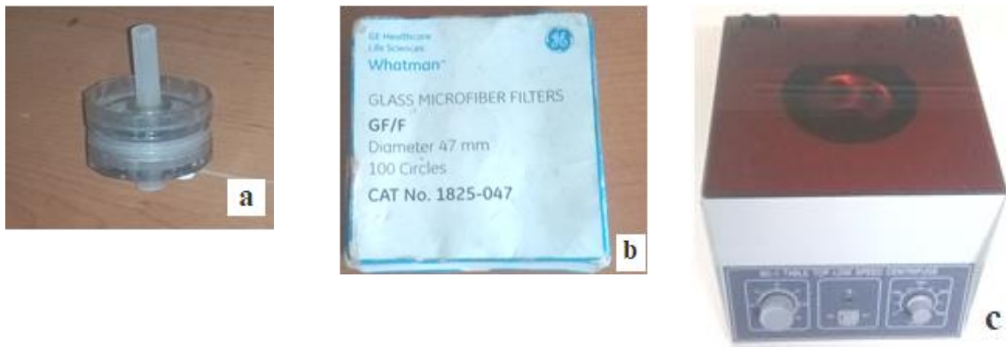
Figure 17 : Matériel de dosage de la chlorophylle a . a : dispositif de filtration ; b : paquet de papier Whatman ; c : centrifugeuse.
