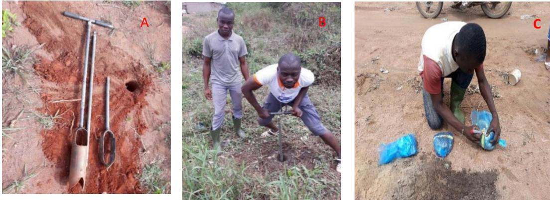
**Figure 35 :** Tarière de prélèvement (A), Prélèvement d'échantillon de sol (B) et étiquetage des échantillons de sol (C)
