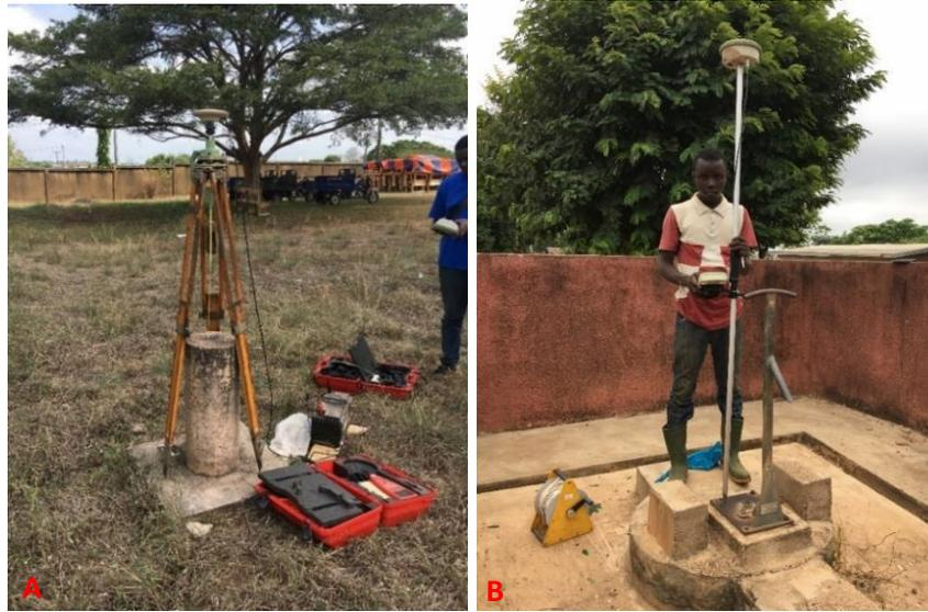
**Figure 41** : Principe d'acquisition et d'installation de l'une des bases à la Mairie de Zoukougbeu (A) ; GPS mobile pour le nivellement du forage de Banoufla (B)
