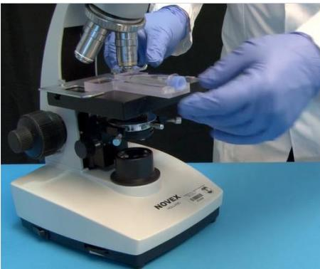
E. Montage du tube collecteur sous le microscope
