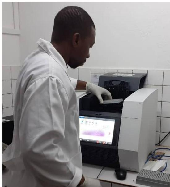
B. Insertion de la microplaque dans la machine qPCR
