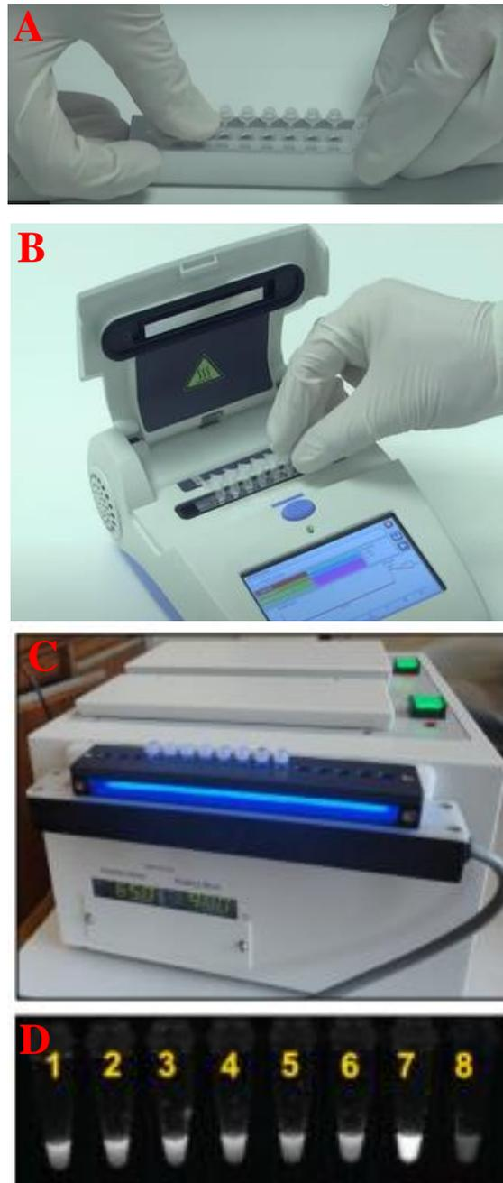
**Figure 23:** Réalisation de la LAMP avec la machine de type incubateur LAMP Génie III (OptiGene)
